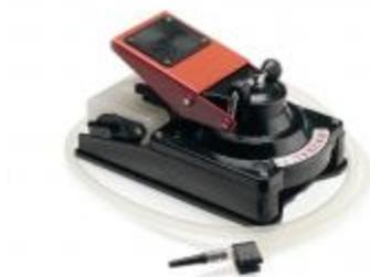
Отсос Uni - Suction Pump обеспечивает эффективную аспирацию в любой ситуации. Отличается небольшим весом ( 2,1 кг ), прочной и неподверженной коррозии конструкцией. Всегда готов к работе, безопасен даже для детей, действует от кислородного источника питания, расход кислорода составляет менее 10 л/мин. При прекращении подачи газа может приводиться в действие ногой или рукой. Уровень вакуума при отсасывании достигает 450 мм ртутного столба (600 миллибар). Емкость резервуара от 600 мл до 2,6 л .
